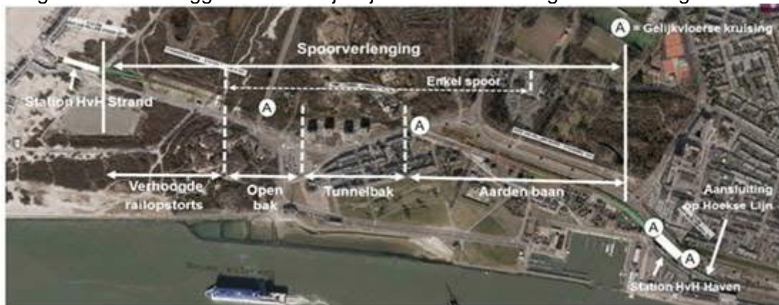
Schematisch overzicht van de werkzaamheden
