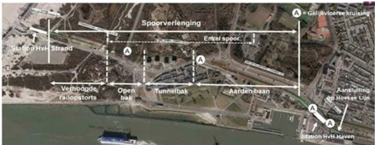
Schematisch overzicht van de werkzaamheden
